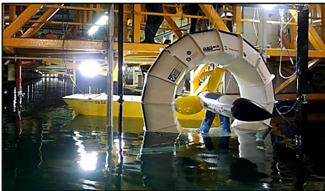
Figura 4. Turbina de corrientes marinas laminada con fibra de vidrio. Fuente: ICTS-CEHIPAR (INTA)
