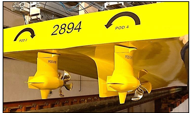
Figura 6. PODs fabricados en impresión 3D con material ABS. Fuente: ICTS-CEHIPAR (INTA).
