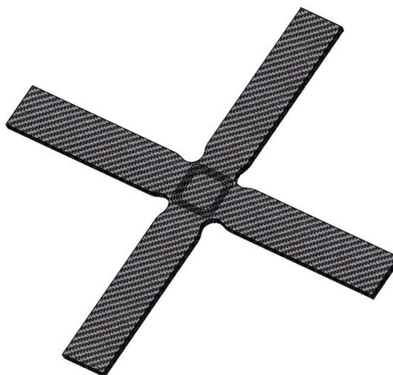
**Figura 1.** Diseño de probeta cruciforme en CAD. Fuente: INTA-UCLM.
