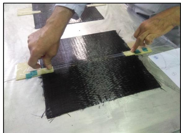
**Figura 4.** Colocación de los sensores de FBGs en el proceso de apilado. Fuente: INTA.
