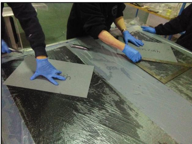
**Figura 3.** Corte manual de las láminas con plantillas de celulosa. Fuente: INTA.
