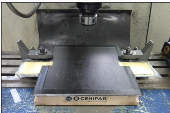
**Figura 6.** Panel de CFRP colocado en útil-bancada de la fresadora. Fuente: INTA.
