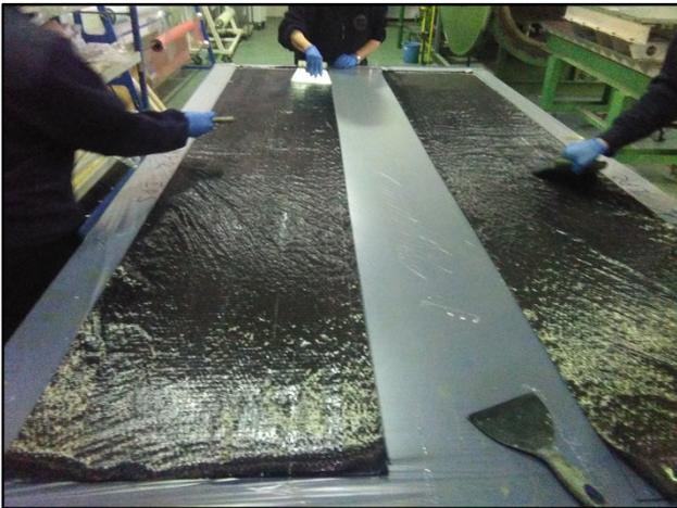
**Figura 2.** Impregnación manual del tejido en el laboratorio de Materiales Compuestos. Fuente: INTA.
