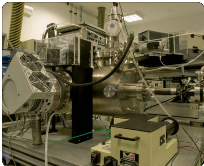
■ Cámara de simulación de atmósferas y superficies planetarias, PASC ( Planetary Atmospheres and Surfaces Chamber ).
