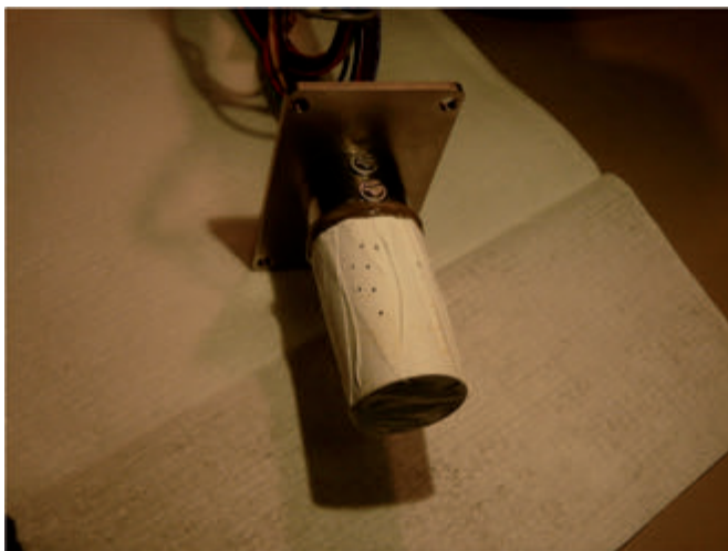
Figura 6: Sensor RHS antes de su integración en el boom 2.
